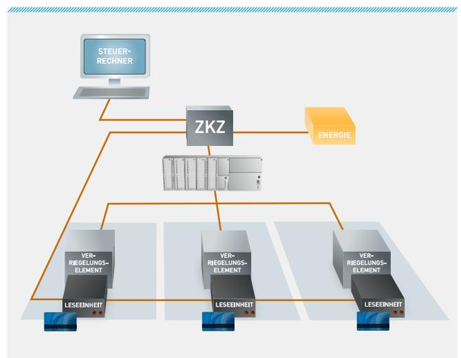
Einige Systeme haben eine serielle Schnittstelle integriert und können so auf die aufwendige Verdrahtung verzichten. Beim Einsatz von mehreren SPS-Modulen werden diese über das Netzwerk (Ethernet) miteinander verbunden, was die Flexibilität und Geschwindigkeit zusätzlich erhöht.
