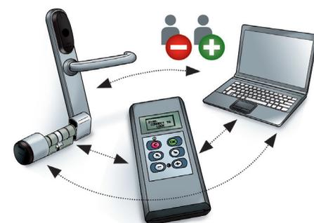
Das System besteht aus einer Kombination von elektronischen Offline- und Online-Zylindern und Beschlügen, die über das Ausweismedium (Karte oder Schlüsselanhänger) zu einem Teil des gesamten Netzwerkes werden.
