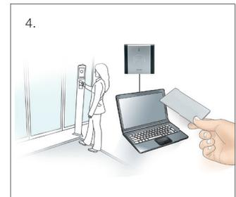
4. Wird eine Online-Tür bedient, erfolgt eine Verifizierung aller Informationen über Zutrittsrechte des Nutzers. Gleichzeitig findet ein Update der Beschläge/Zylinder mit den aktuellsten Blacklisten-trägern und dem Batteriestatus statt.
