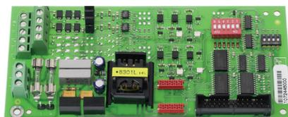
Das ACS-8 kommuniziert über das Kommunikationsmodul mit den angeschlossenen RS-485-Teilnehmern. Standardmäßig sind im Kommunikationsmodul zwei getrennte RS-485-Schnittstellentreiber integriert. Maximal können bis zu 32 Teilnehmer gleichzeitig verwaltet werden. Pro ACS-8 können bis zu 2 Kommunikationsmodule eingesetzt werden. Damit können max. 4 getrennte RS-485 Bus-Systeme mit bis zu 8 Halbsträngen entstehen. Damit sind auch die komplexesten Topologien zu realisieren.
