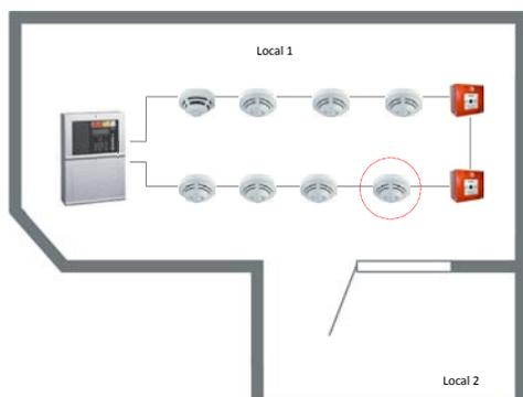
Sur cet exemple, un système de détection incendie est déjà installé avec plusieurs détecteurs dans le local 1.
