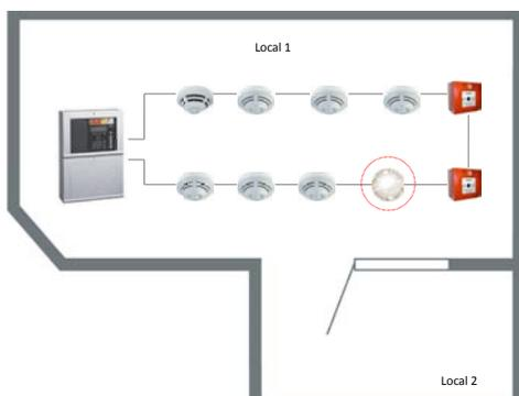
Une installation temporaire ou une extension est maintenant demandée dans le local 2. Un récepteur Gateway est inséré entre le détecteur IQ8Quad et son socle.
