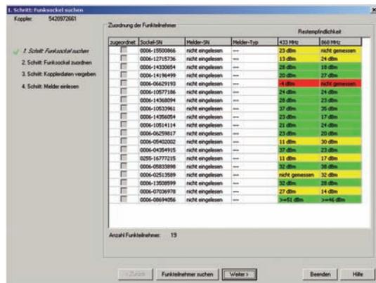
Un signal vert indique un signal de qualité entre les 2 éléments radio contrôlés. La communication est optimale.
