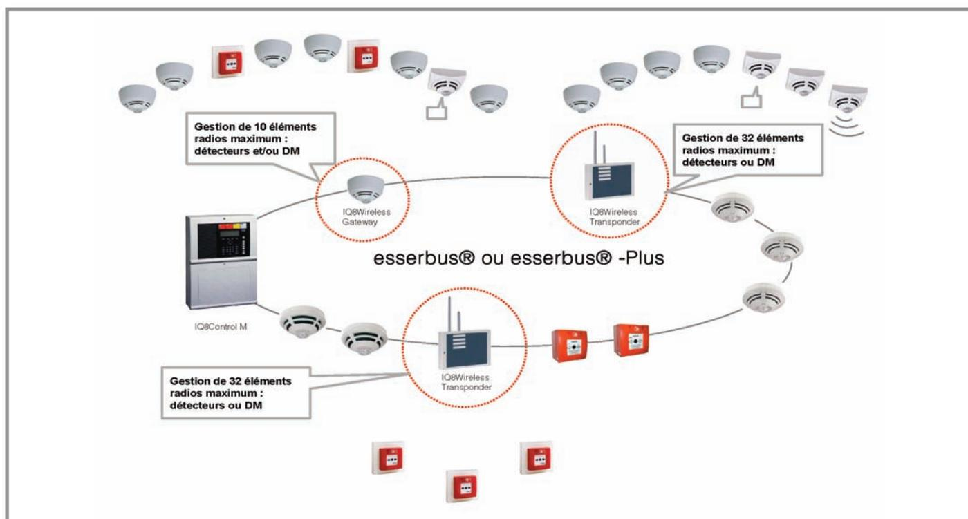
Tous les détecteurs adressables de la gamme IQ8 (O, O<sup>2</sup>T, OTBlue, Thermostatiques) peuvent bénéficier d'une mise en oeuvre sans fil, par simple insertion d'une embase radio entre le détecteur et son socle.
