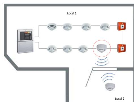
1 ou plusieurs détecteurs IQ8Wireless sont maintenant installés dans le local 2 et communiquent sur le bus via le wireless Gateway.
