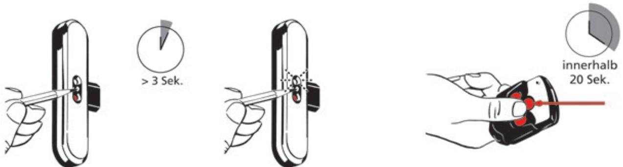
1. Schließen Sie die Tür und betätigen Sie **länger als 3 Sek.** die Programmiertaste zwischen der roten und grünen LED des Steuerungsgehäuses mit einem dünnen Gegenstand (z. B. Kugelschreiber oder Bleistift).
