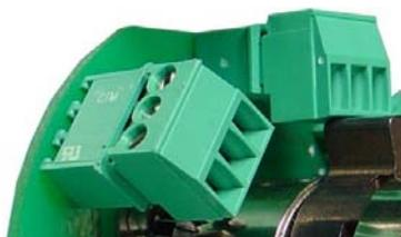
Die Code- oder Code-/Leser-Tastatur ist mit steckbaren Schraubklemmen versehen für einen Drahtquerschnitt von 0.05 bis 1.5mm<sup>2</sup>. Zur Verdrahtung des RS485-BUS ist das abgeschirmte Kabel Typ ABKAB 2x2+2HAL (2x2 0.22mm<sup>2</sup> paarweise verdreht und 2x 0.75mm<sup>2</sup>) zu verwenden.
