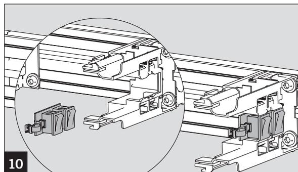
Das restliche Kabel aufwickeln und mit einem Kabelbinder am mittleren Halter befestigen.
