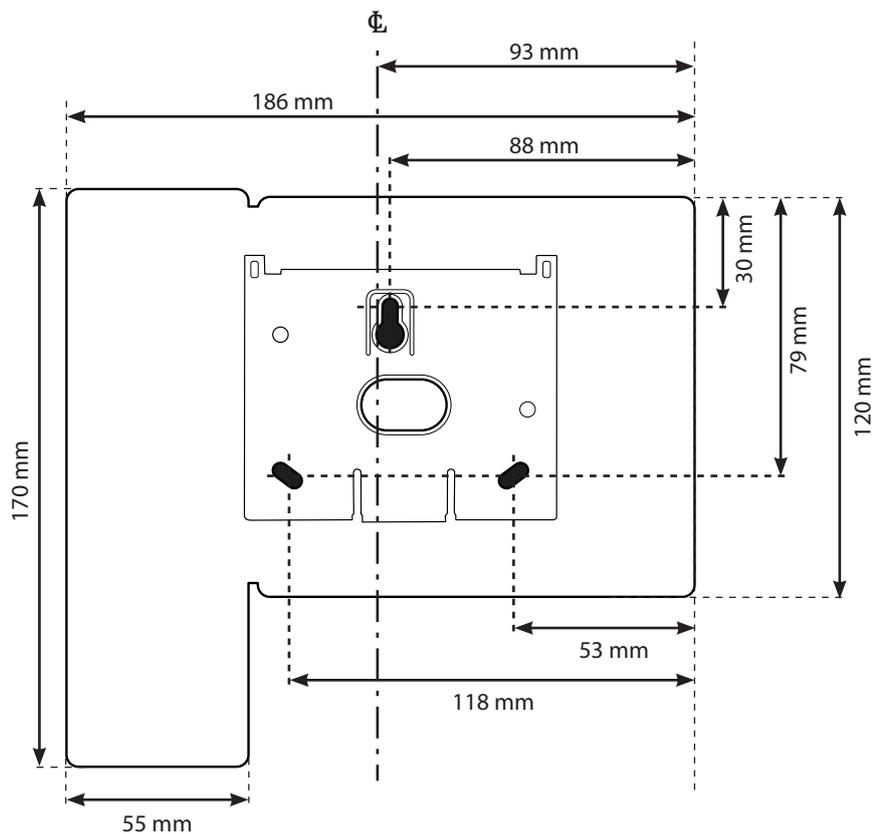
Legen Sie den Aufstellungsort des Monitors fest. Die obere rechte Ecke des Geräts dient als Referenzpunkt für Bohrungen und Bemaßung. Schrauben und Dübel werden mitgeliefert.
