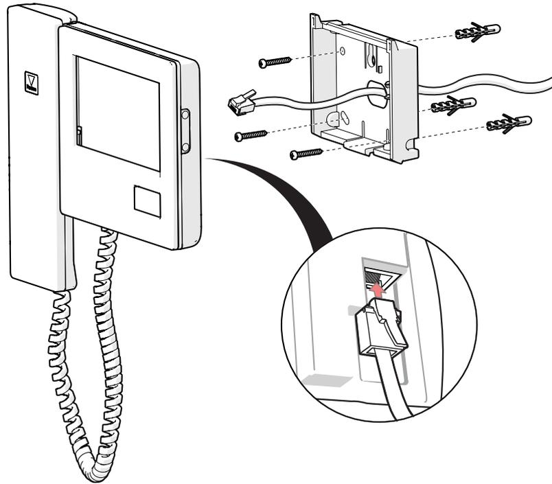
Falls Sie ein konfektioniertes Kabel verwenden, schieben Sie dieses durch die Halterung und drücken Sie es in die Fassung auf der Rückseite des Monitors.
