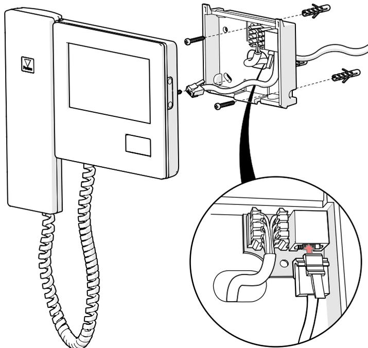
Befestigen Sie den Monitor in der Halterung. Haken Sie hierzu das Gerät an den oberen beiden Stiften ein und drücken Sie das untere Teil in die Halterung, bis es mit einem Klickton einrastet.
