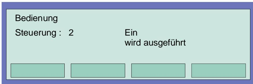
Abb. 31: Displayanzeige zur Einschaltung des Relais 2
