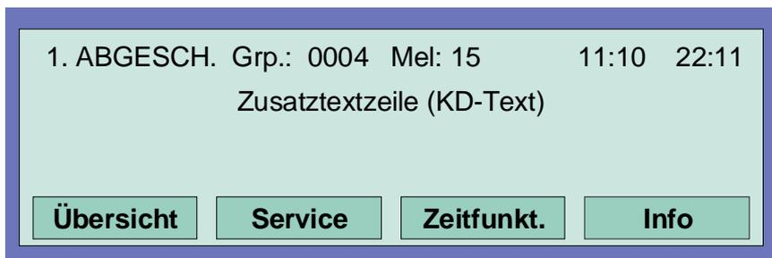
Abb. 21: Displayanzeige zur Abschaltungsmeldung in der Zustandsanzeige
