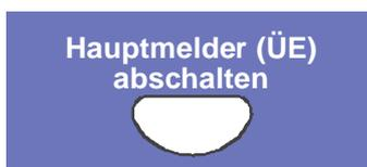
Die Ansteuerung der Übertragungseinrichtung (ÜE) wird ein- bzw. abgeschaltet (Wechselfunktion). Abschaltungen werden optisch mit der Sammelanzeige >Abschaltung< angezeigt.
