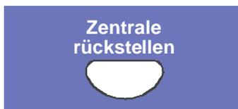
Alle ausgelösten Brandmelder, Meldergruppen, Anzeigen und technische Alarmmeldungen (TAL-Alarm) werden in den meldebereiten Normalzustand zurückgesetzt.
