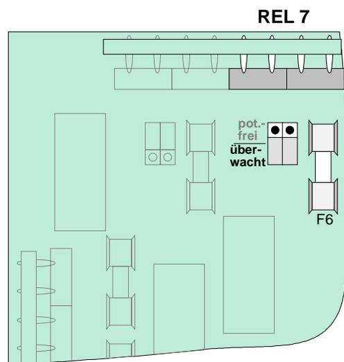
Abb. 41: Prinzipbeschaltung der Betriebsart >plusschaltend / überwacht< und Lage der Steckbrücken
