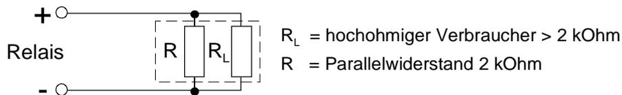
Abb. 42: Prinzipbeschaltung der Betriebsart plusschaltend / überwacht
