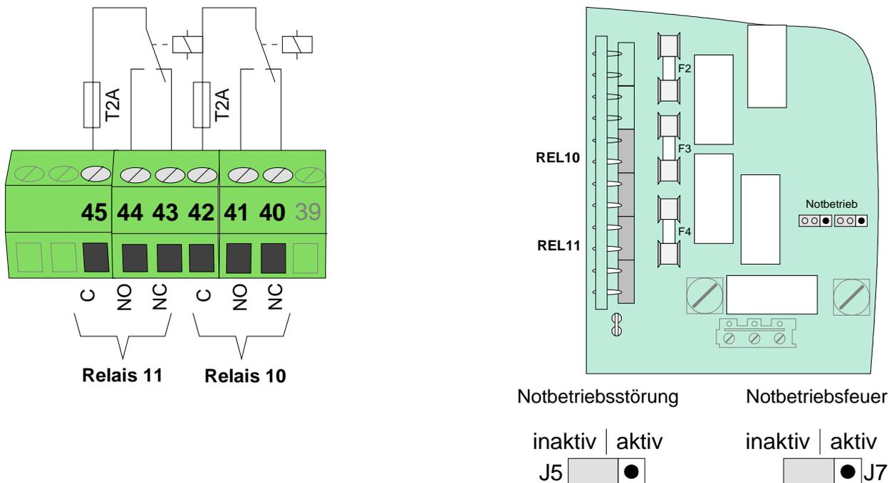
Abb. 46: Kodierbrücken zur Einstellung der Notbetriebsfunktion (Relais 10 und 11)
