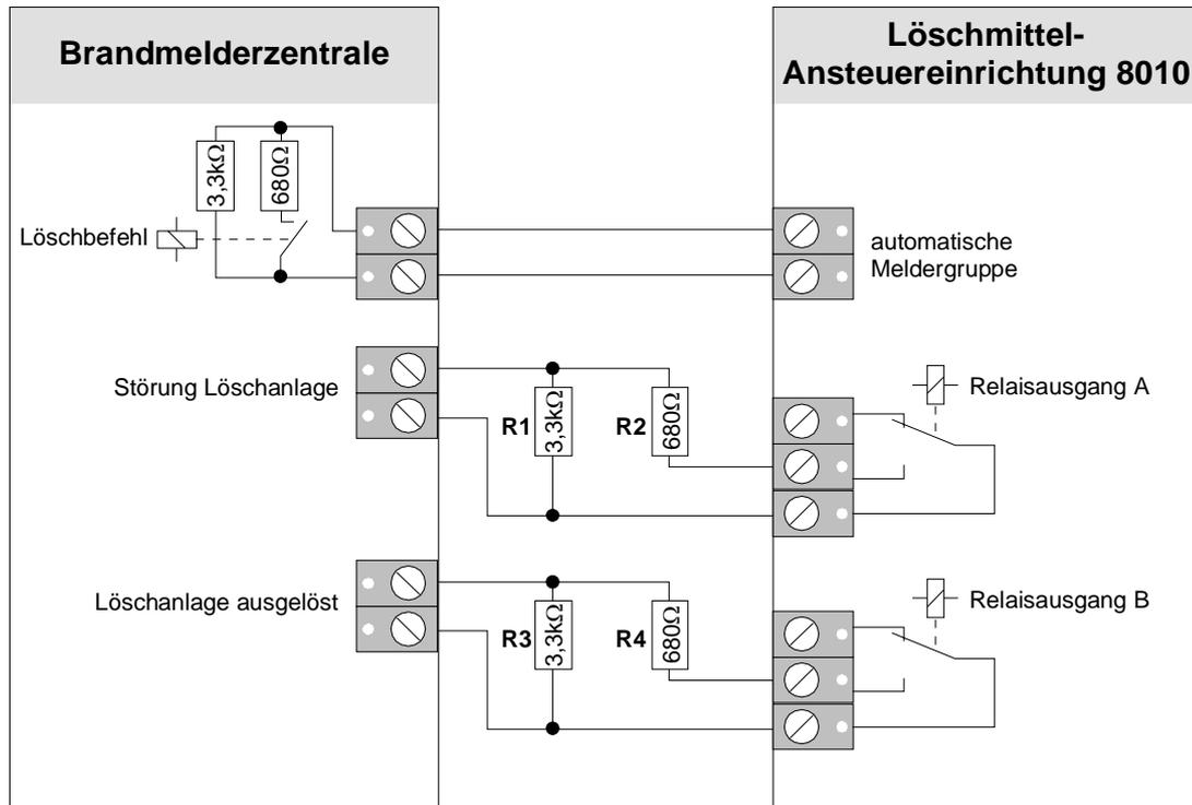
Abb. 45: Standardschnittstelle - Löschen
