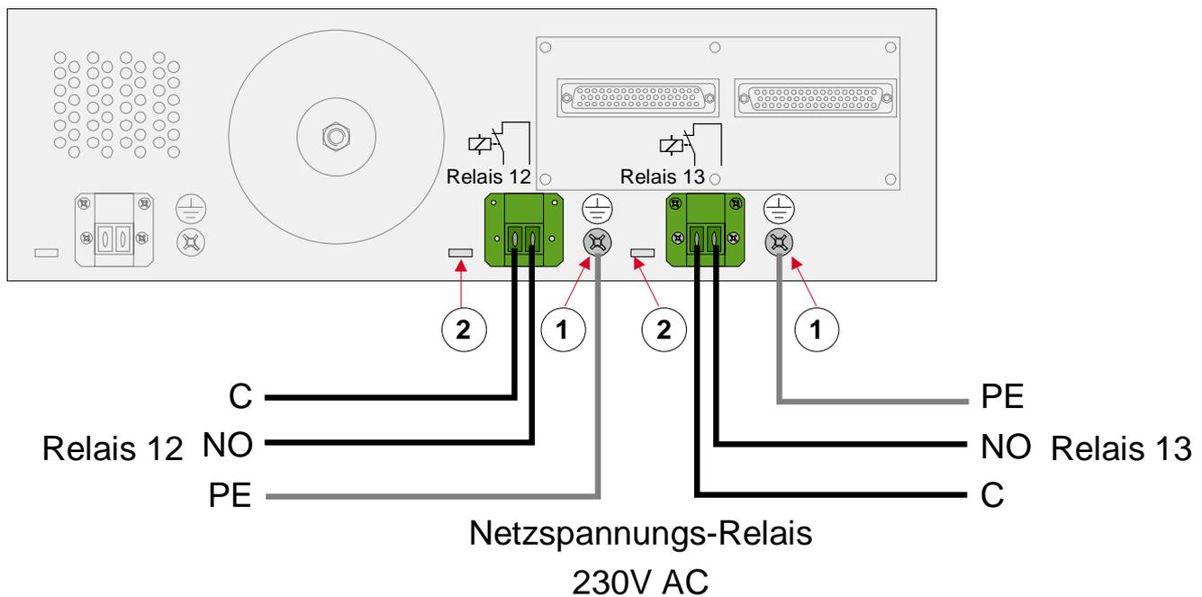
Abb. 44: Prinzipbeschaltung der Netzspannungsrelais 12 und 13
