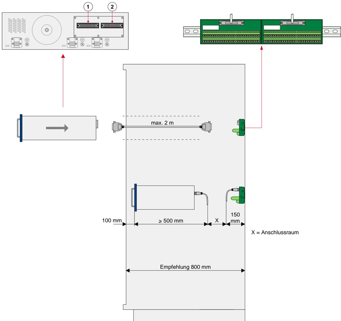
Abb. 21: Kabelverbindung zur externen Anschlussstechnik auf der C-Schiene
