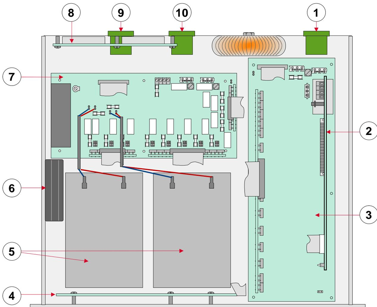
Abb. 25: Lage der Baugruppen (Draufsicht bei geöffnetem Gehäuse)
