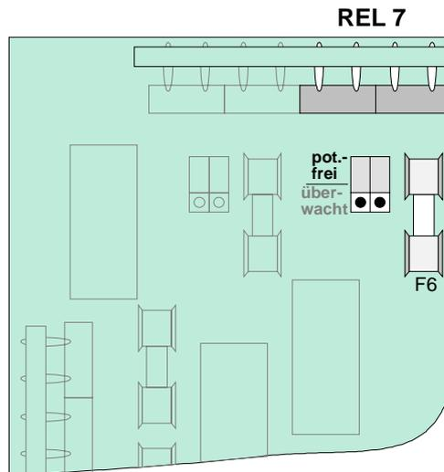
Abb. 40: Prinzipbeschaltung der Betriebsart "potentialfrei" und Lage der Steckbrücken
