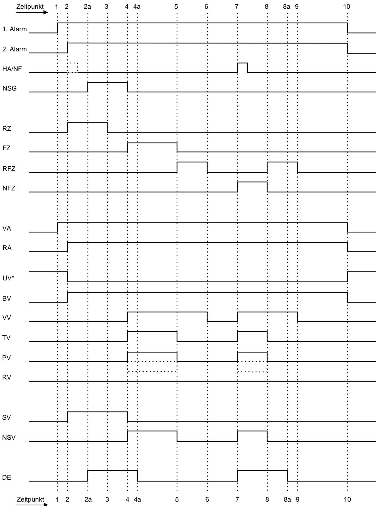
Abb. 48: Ablaufdiagramm Löschmittelsteuerung
