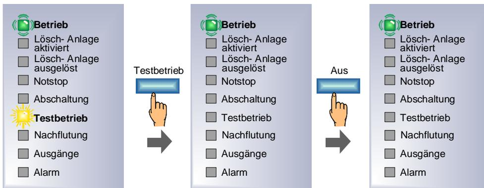
Abb. 14: Anzeige und Bedienung – Abschaltung des Revisionsbetriebes
