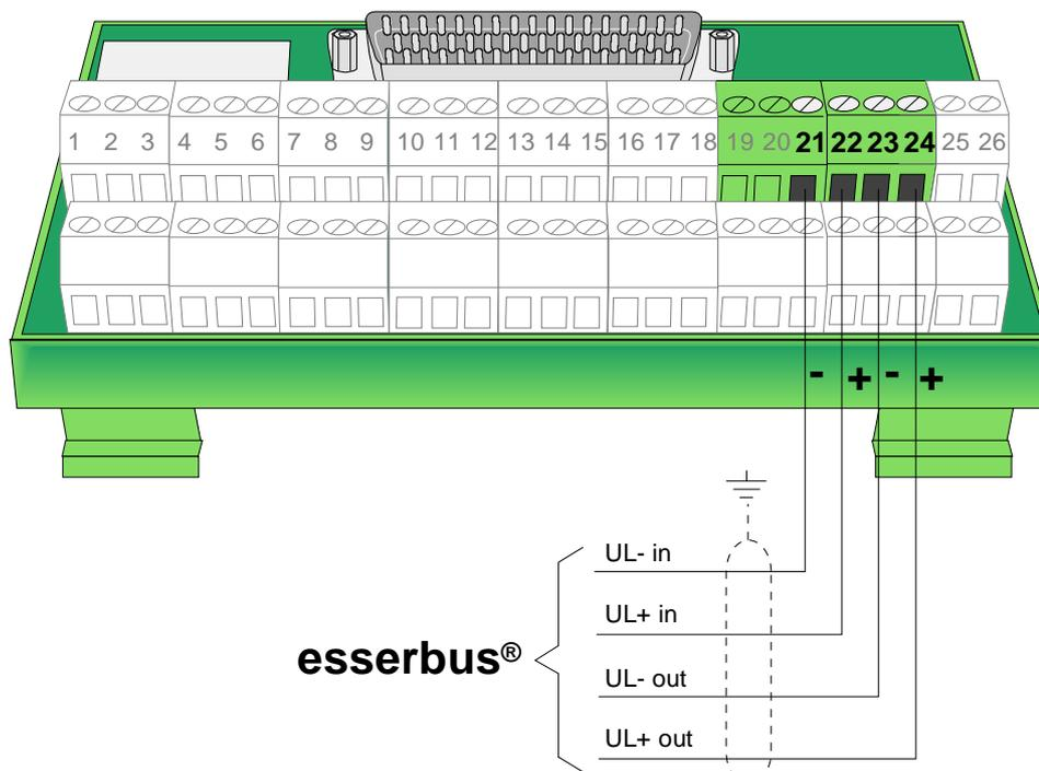
Abb. 47: Anschlussklemmen für die Analog-Ringleitung (Typ Phoenix)
