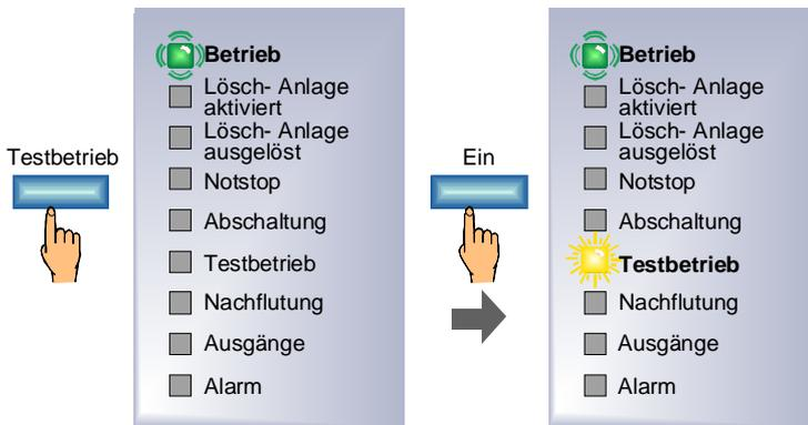
Abb. 13: Anzeige und Bedienung – Einschalten des Revisionsbetriebes
