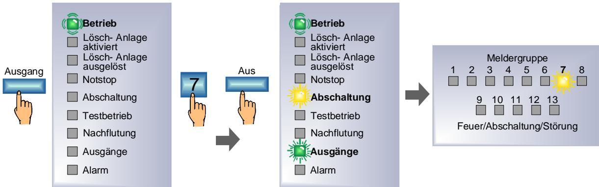
Abb. 9: Anzeige und Bedienung – Abschaltung Relaisausgang Nr. 7
