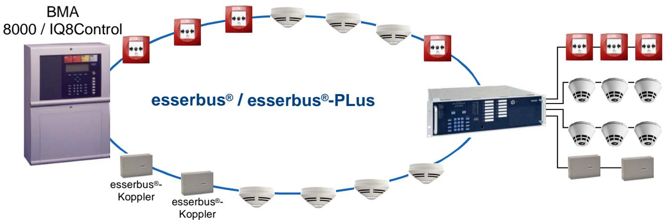
Abb. 51: Anschluss der Löschmittel-Ansteuereinrichtung an die Analog-Ringleitung
