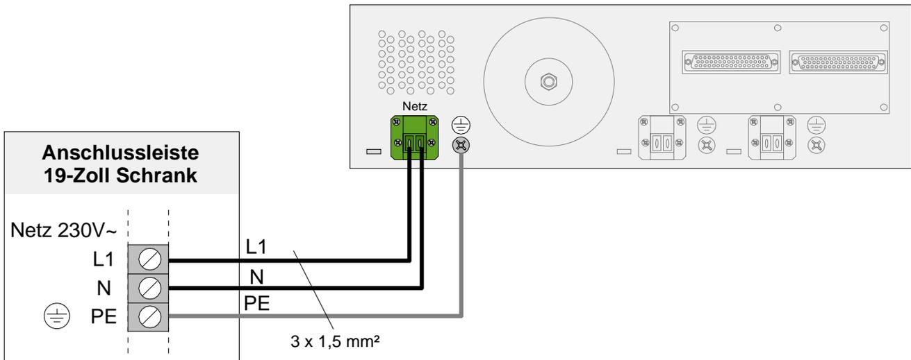
Abb. 23: Anschluss der 230 V AC-Nennspannung und des PE-Schutzleiters (Prinzipdarstellung)
