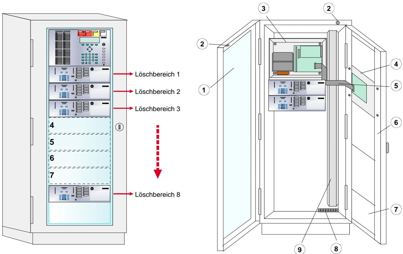
Abb. 20: Vorderansicht beim 19-Zoll-Schrankeinbau (Beispiel mit Brandmelderzentrale)
