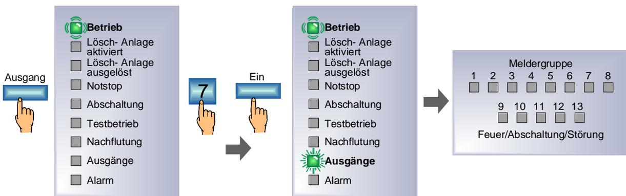
Abb. 10: Anzeige und Bedienung – Einschalten des Relaisausganges Nr. 7
