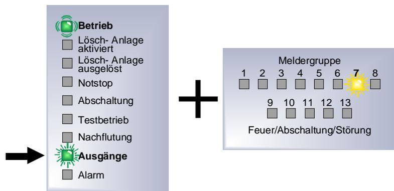
Abb. 3: Zustandsanzeige der Ausgänge (Beispiel mit Ausgang Nr. 7)
