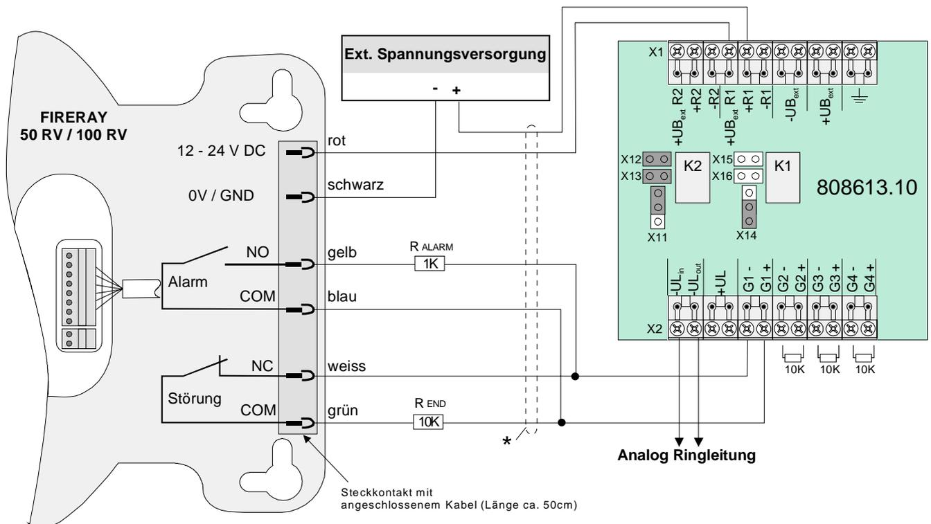
\* Die Kabelabschirmung muss an den entsprechenden Klemmen aufgelegt werden !
