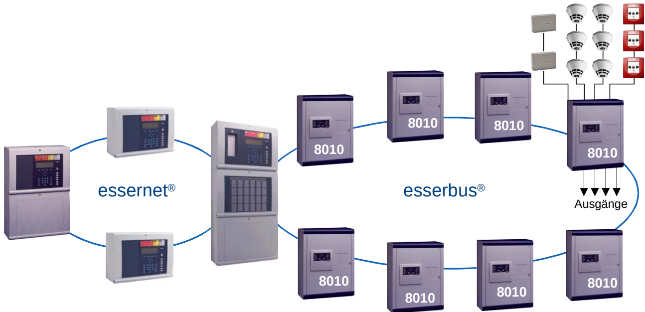
Abb. 38: Löschmittel-Ansteuereinrichtung 8010 im Brandmeldesystem 8000/IQ8Control
