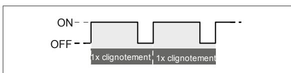
Fig. 10 Exemple séquence de clignotement : 1 x clignotement
