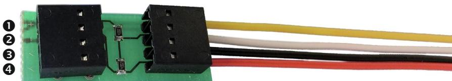
Fig. 3 Module de terminaison AM-142
