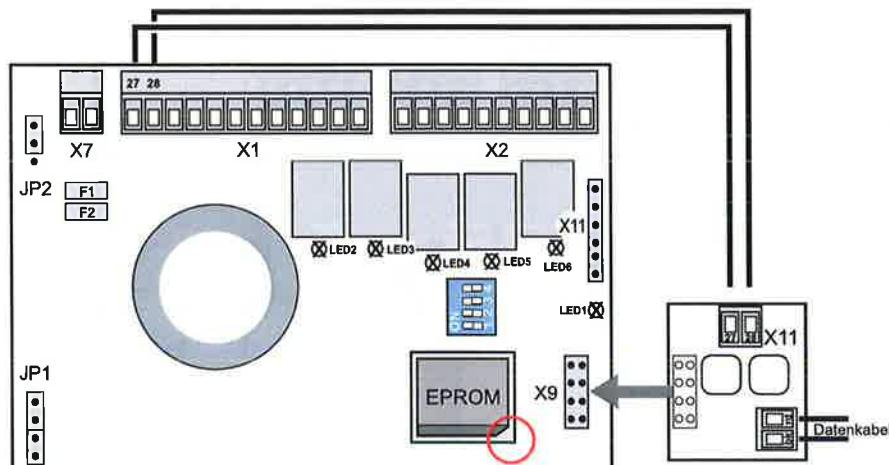
Il circuito stampato aggiuntivo è già collegato all'unità di comando tramite il cavo di cablaggio [X1: 27/28]. Nell'unità di comando, inoltre, è già disponibile la EPROM (nuovo firmware).
