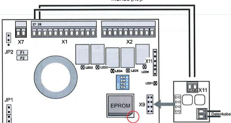
Der Zusatzprint ist bereits mit dem Verbindungskabel auf das Befehlsteil [X1: 27/28] verdrahtet. Zusätzlich ist bereits das EPROM (neue Firmware) eingesetzt.
