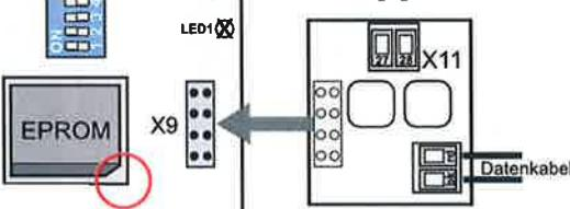
Le circuit imprimé supplémentaire est déjà câblé avec le câble de connexion sur la partie commande [X1: 27/28]. Par ailleurs, l'EPROM (nouveau micrologiciel) est déjà installé.
