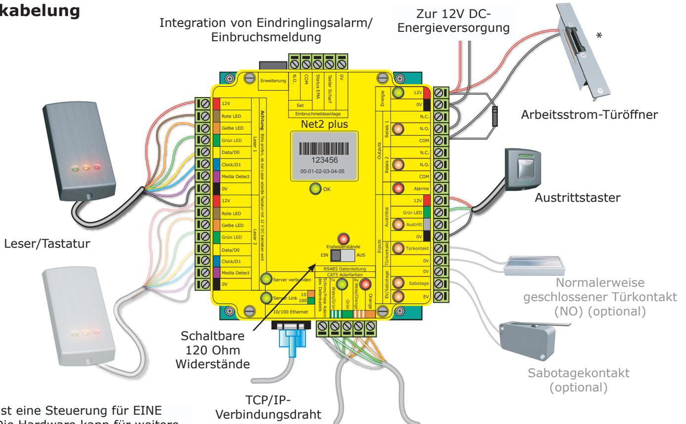
Dies ist eine Steuerung für EINE Tür. Die Hardware kann für weitere Funktionen eingerichtet werden ist aber nicht zur Steuerung einer zweiten Tür ausgelegt.
