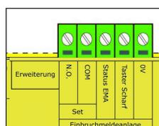
**Tester Scharf** - Bestätigungstaster - 0 Volt und Tester Scharf verkabeln.
