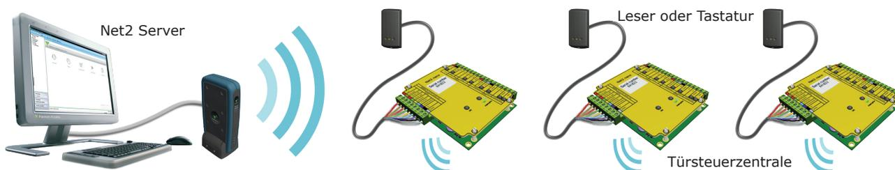
Standardmässig sind alle LEDs eingeschaltet. Gewählter Zutritt wird angezeigt indem die grüne LED alleine blinkt; wenn er verwehrt wurde blinkt die rote LED.
