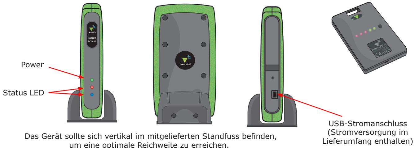
Das Set besteht aus der Basisstation und der tragbaren Karte. Die Karte zeigt die Empfangsbedingungen anhand einer Reihe von LEDs. Eine Verbindung zu einem PC ist nicht erforderlich.
