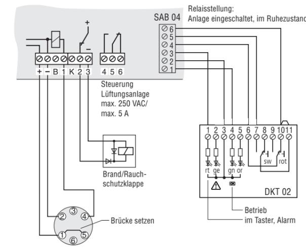
**Hinweis:** Bei Verwendung des SAB 04 mit einem DKT 02 muss der Jumper auf dem SAB 04 abgezogen werden!
