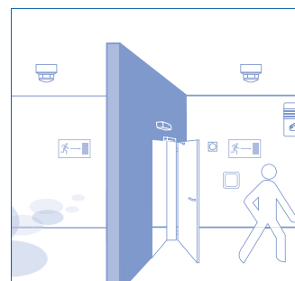
Les voies d'évacuation restent sans fumée
