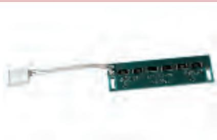
Kit de chauffage pour détecteur 6500 (en cas de risque de condensation).
