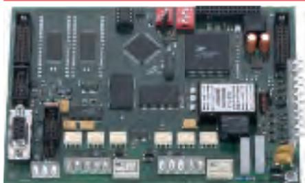
La carte IGIS Loop permet d'effectuer la mise en réseau du CMSI8000 (32 CMSI max.). La distance entre 2 utilisateurs est maximum 1200 m.
