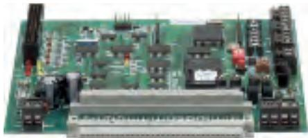
L'interface série pour raccordement au réseau essernet® peut être utilisée pour relier WINMAGplus au système de détection incendie. L'unité comprend un emplacement pour un module essernet® permettant une connexion réseau.
