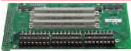
**Module d'extension avec 3 emplacements supplémentaires pour micromodules**
