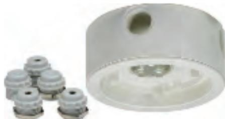
Adaptateur étanche pour l'application avec presse-étoupes ou chemins de câbles vissées, protégé contre le ruissellement d'eau, et équipé de 3 entrées de câble PG11 et des clips permettant le verrouillage des socles série 2000 ou 781590.
