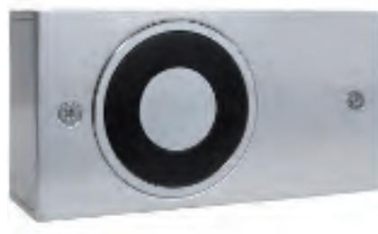
Le déclencheur électromagnétique pour issue de secours assure le verrouillage des issues de secours en fonctionnement normal et permettent au moment d'une alarme incendie la libération de l'issue par suppression de sa tension d'alimentation électrique de type rupture de courant.
