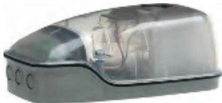
Boîtier pour détecteur de gaine équipé des tubes venturi 781456, 781457 ou 781458 en combinaison avec un détecteur optique de fumée. Le tube Venturi s'installe à l'intérieur de la gaine. Le détecteur incorporé est accessible en retirant le couvercle plastique transparent. Durant le fonctionnement, le voyant d'alarme du détecteur est visible.
