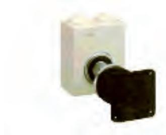
Le déclencheur électromagnétique assure le maintien magnétique d'une partie mobile et d'une partie fixe (portes coupe feu, équipement de désenfumage...). Ce maintien est supprimé dès la réception d'un ordre électrique de type rupture de courant.
