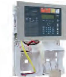
Équipement de Contrôle et de Signalisation adressable IQ8Control  $\mu$  en rack, capacité 512 points de détection, avec 1 fonction UGA, équipé d'une carte d'extension capacité 3 micromodules pour fonctionnement sur esserbus® ou esserbus-Plus®.
