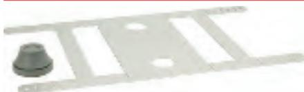
Kit de montage pour boîtier 781453, à utiliser sur les gaines rondes et isolées. Dans ce cas, le trou de montage du tube sur le côté de montage du boîtier 781453 devra avoir un diamètre de 50mm. L'étanchéité est assurée par un joint en caoutchouc.
