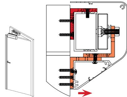
Montage sur porte affleurée avec angle de montage Z et L
