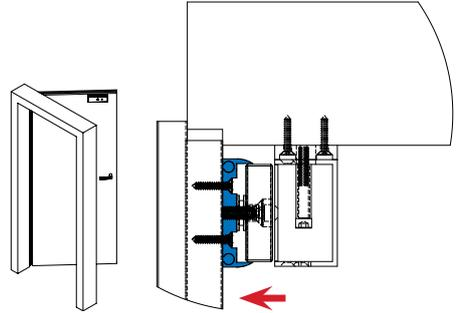
Montage sur linteau pour porte ouvrant sur l'extérieur avec set de montage pour contre-plaque
