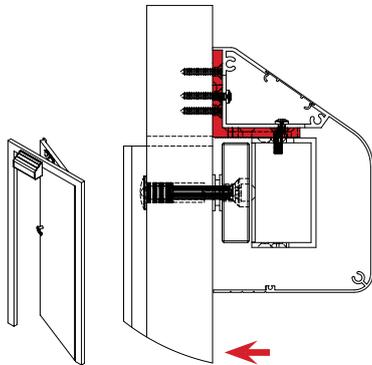
Montage sur porte affleurée avec angle de montage L
