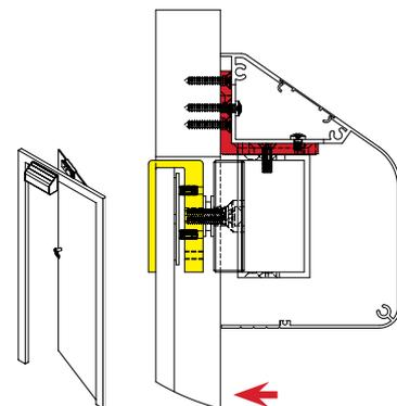
Montage pour porte ouvrant sur l'extérieur avec angle de montage L et set de montage U
