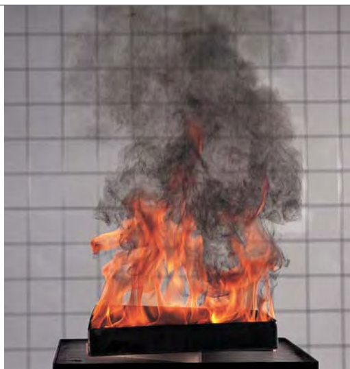
Feu test : n-heptane
