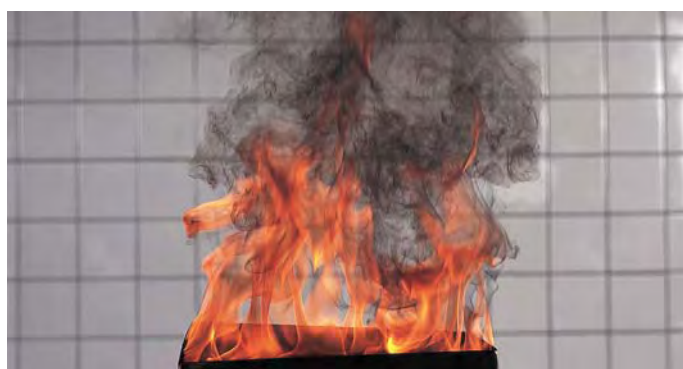
Feu de test 5: Feu liquide (n-heptane)
