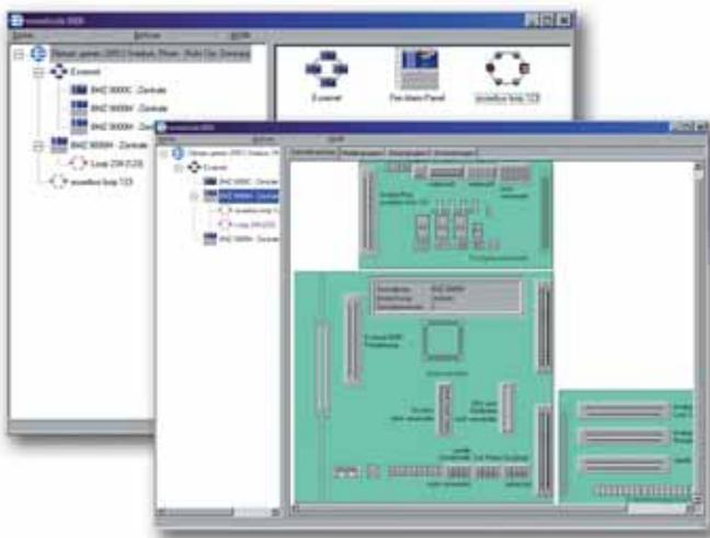
**tools 8000** macht unabhängig von Ort und Zeit. Nach erfolgter Topologie-Erkennung kann die Programmierung und Konfigurierung des Rings auch bequem zu Hause vorgenommen werden. Lediglich das Überspielen der Daten in das Brandmeldesystem erfolgt anschließend einfach per USB vor Ort. Darüber hinaus übernimmt **tools 8000** vielfältige Aufgaben über den gesamten Lebenszyklus der Brandmeldeanlage und deckt dabei alle Phasen von der Inbetriebnahme bis zur regelmäßigen Instandhaltung ab.
