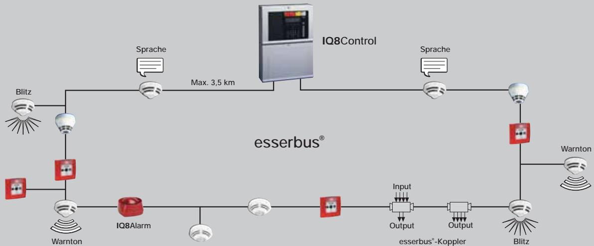
Der esserbus®-Plus: die derzeit sicherste und ökonomischste Form der Alarmierung. Das Prinzip ist einfach: Alle Systemkomponenten sitzen nicht wie häufig auf verschiedenen Stichleitungen, sondern ausschließlich voll adressierbar auf dem Ringbus. Der speist die Alarmgeber kurzschluss- und unterbrechungstolerant direkt aus der zweiadrigen Analogringleitung.
