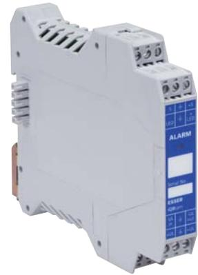
Das Technische Alarm Modul IQ8TAM wird als Busteilnehmer an die Analog-Ringleitung der Brandmeldesysteme 8000 und IQ8Control angeschlossen und ermöglicht die Erfassung, Weiterleitung und Einzelanzeige von technischen Alarmen. Eine eigene Spannungsversorgung des Moduls ist nicht erforderlich, da diese über den esserbus® erfolgt.
