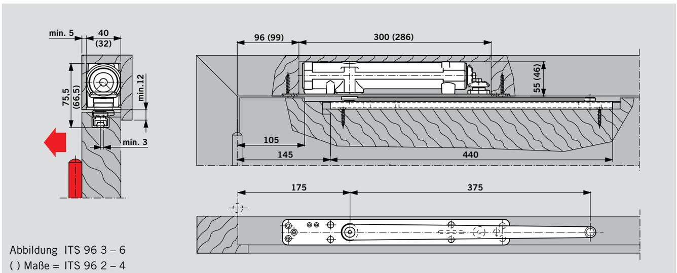
Türschließer ITS 96 mit Gleitschiene G 96 N20 in einer Holz
