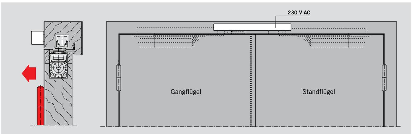
Rauchmeldezentrale RMZ auf der Bandseite in Verbindung mit ITS 96 GSR-EMF
