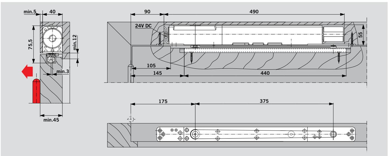
Türschließer ITS 96 FL mit Gleitschiene G 96 N20 in einer Holztür in **Kopfmontage**
