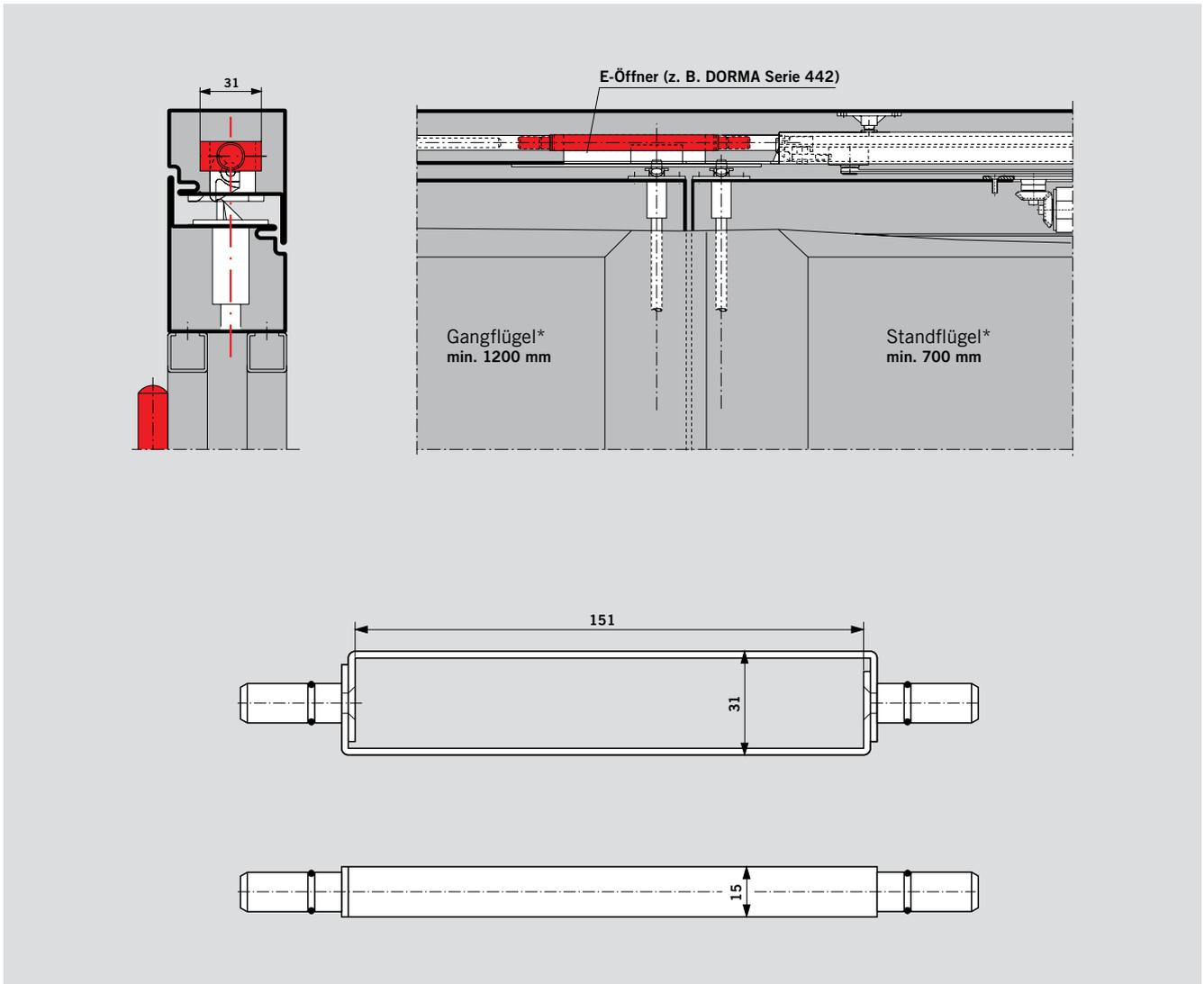
Verbindungsrahmen für **G 96 GSR** für die Verwendung an Türen mit E-Öffner bzw. oberer Türverriegelung.
