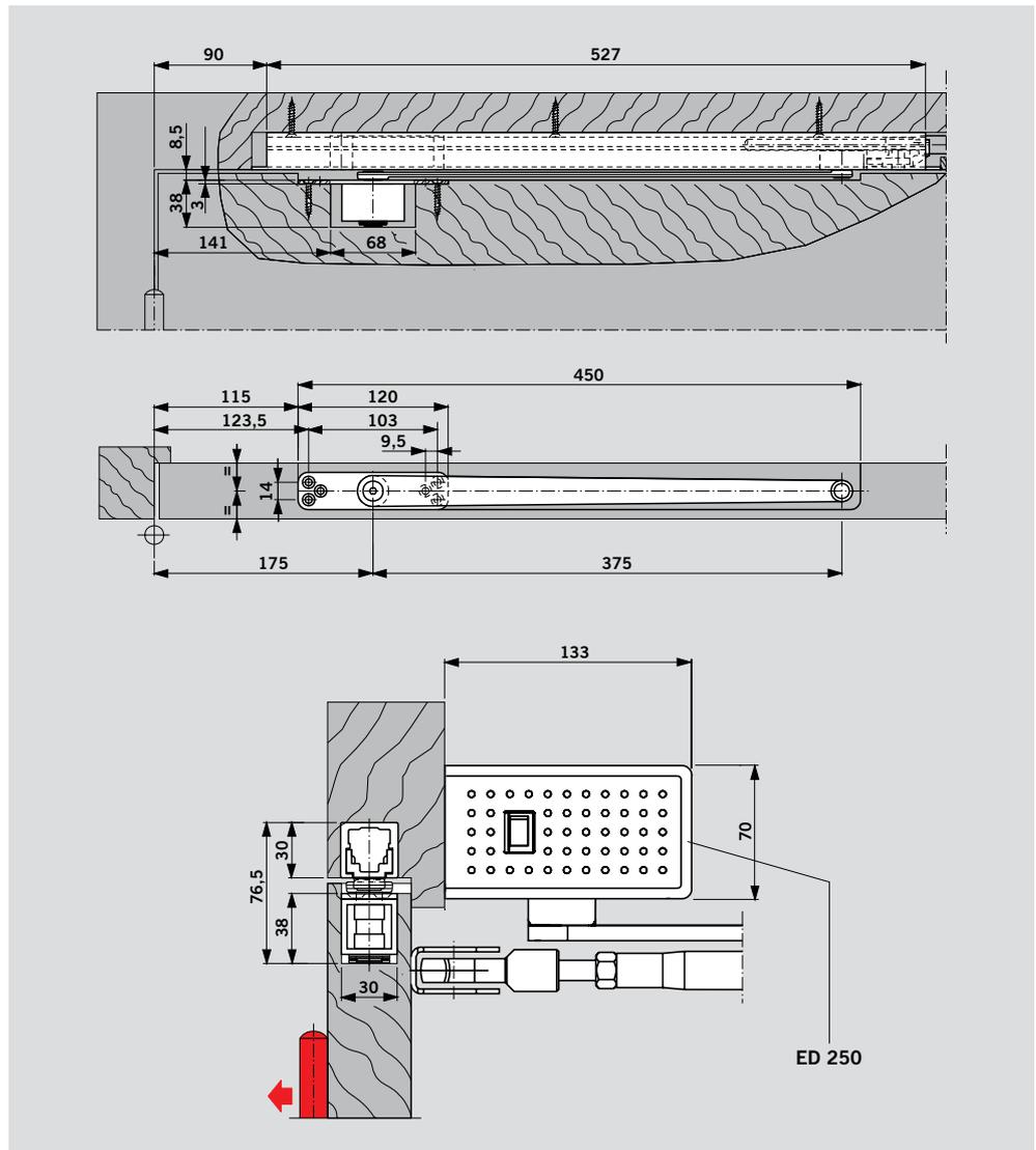
Das Drehlager kann in Verbindung mit der Gleitschiene G 96 N20 auch als **Öffnungsbegrenzung** eingesetzt werden.
