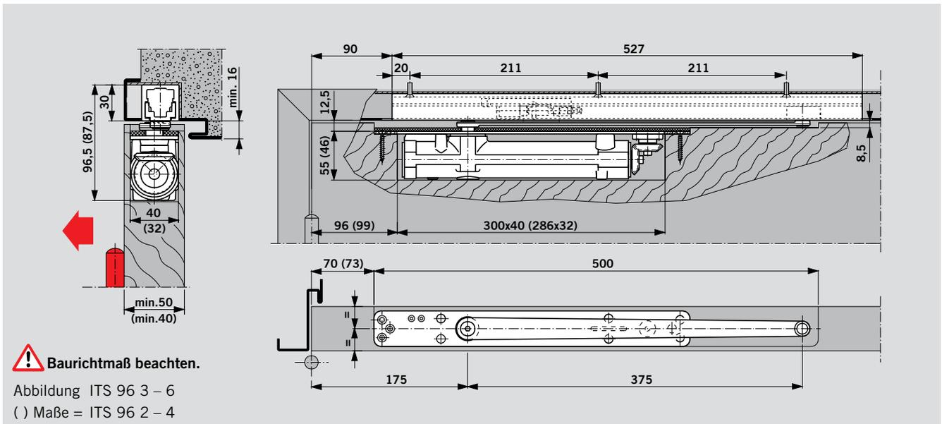
Türschließer ITS 96 mit Gleitschiene G 96 EMF in einer **Holz**tür
