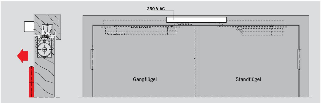
Rauchmeldezentrale RMZ auf der Bandseite in Verbindung mit ITS 96 FL GSR
