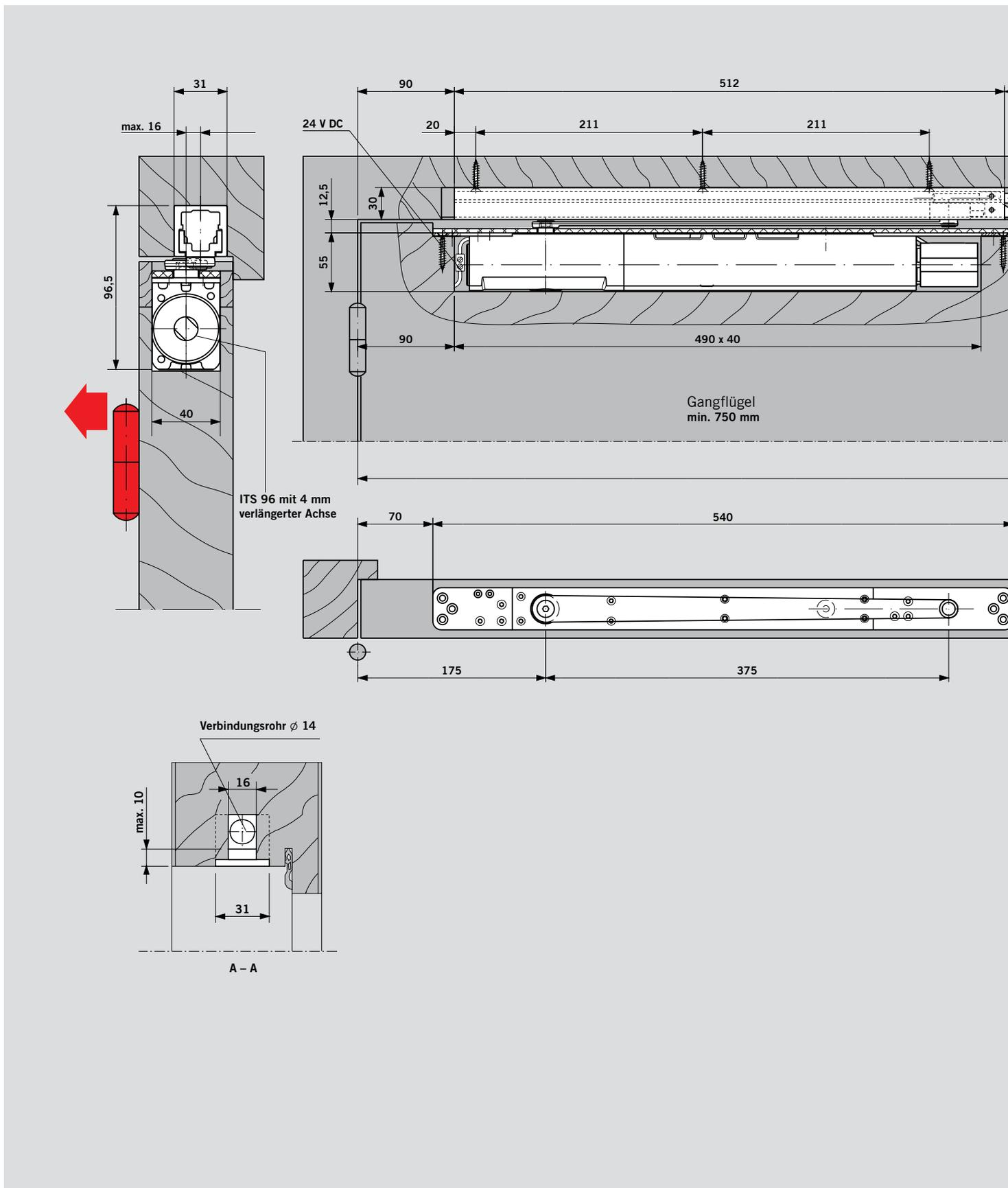
Türschließer ITS 96 FL am Gangflügel und ITS 96 am Standflügel mit Gleitschiene G 96 GSR
