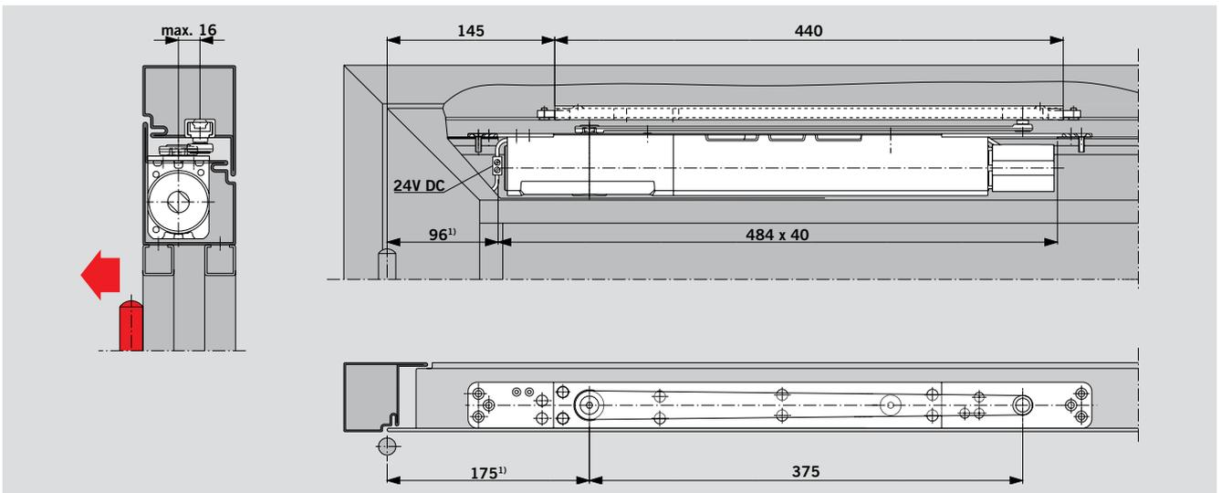
Türschließer ITS 96 FL mit Gleitschiene G 96 N20 in einer **Profiltür**
