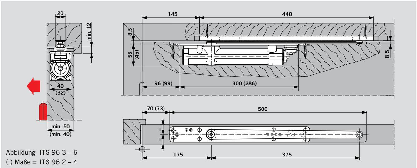
Türschließer ITS 96 mit Gleitschiene G 96 N20 in einer **Holz**tür
