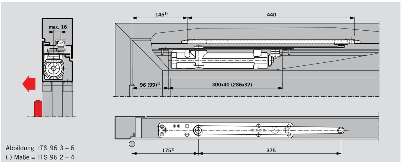
Türschließer ITS 96 mit Gleitschiene G 96 N20 in einer **Profil**tür
