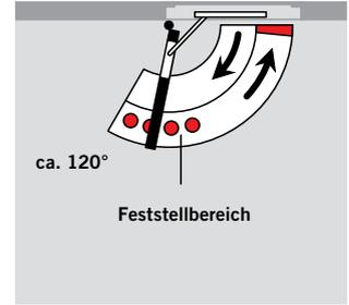
Die Rastfeststelleinheit **RF** ermöglicht ein exaktes Feststellen von Türen ohne Rückfederung bis zu einem Öffnungswinkel von ca. 120°.
