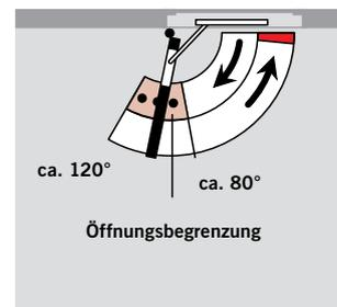
Die Gleitschiene umfasst Hebel, Gleitschiene, Gleitstück, Öffnungsbegrenzung und Befestigungsschrauben und kann mit beiden Türschließergrößen des ITS 96 kombiniert werden.
