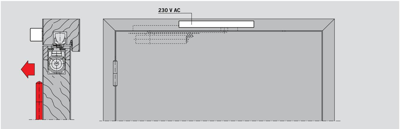
Rauchmeldezentrale RMZ auf der Bandseite in Verbindung mit ITS 96 EMF
