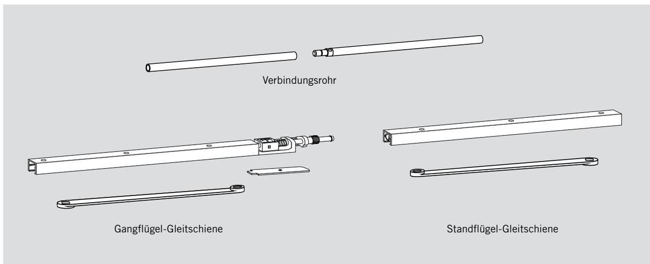
Ein Gleitschienen-Schließfolgeregler 96 GSR umfasst eine Gang- und Standflügel-Gleitschiene mit Öffnungsbegrenzung, ein Verbindungsrohr, eine Abdeckung für den Lagerbock der Gangflügel-Gleitschiene und zwei Hebel.
