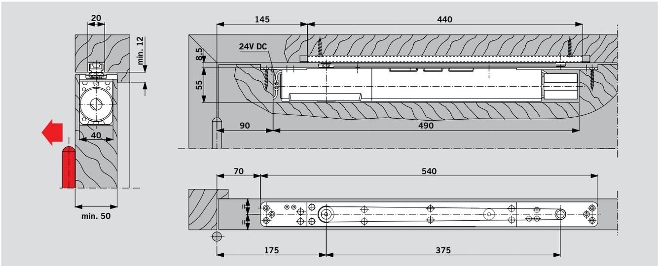
Türschließer ITS 96 FL mit Gleitschiene G 96 N20 in einer **Holztür**
