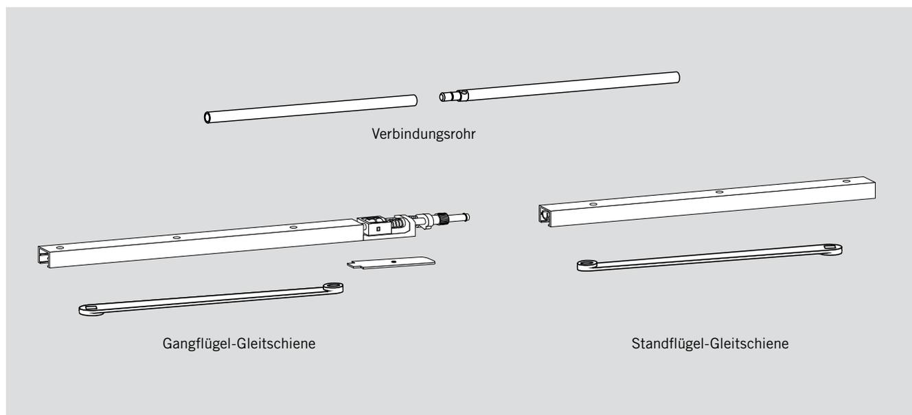
Ein Gleitschienen-Schließfolger umfasst eine Gang- und Standflügel-Gleitschiene mit Öffnungsbegrenzung, ein Verbindungsrohr, eine Abdeckung für den Lagerbock der Gangflügel-Gleitschiene und zwei Hebel.
