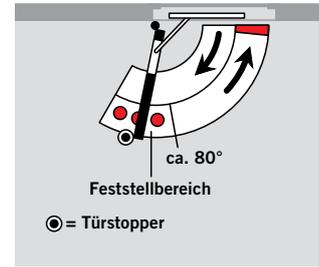
Die Gleitschiene ermöglicht ein exaktes Feststellen der Tür ohne Rückfederung. Der Feststellpunkt ist auf einen Öffnungswinkel zwischen ca. 80° und 120° einstellbar.
