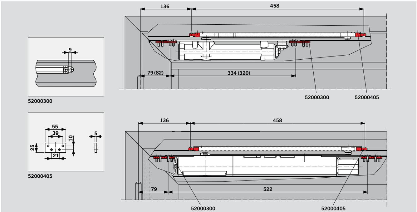
Befestigungselemente für **G 96 N20** und Befestigungsplatte für **ITS 96 / ITS 96 FL**
