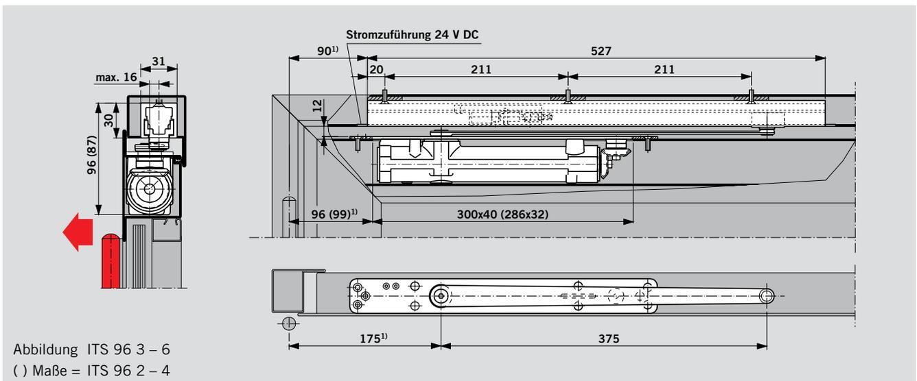
Türschließer ITS 96 mit Gleitschiene G 96 EMF in einer **Profiltür**
