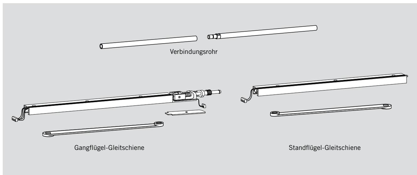
Ein Gleitschienen-Schließfolgerer G 96 GSR-EMF umfasst eine Gang- und Standflügel-Gleitschiene mit elektromechanischer Feststellung, ein Verbindungsrohr, eine Abdeckung für den Lagerbock der Gangflügel-Gleitschiene und zwei Hebel.
