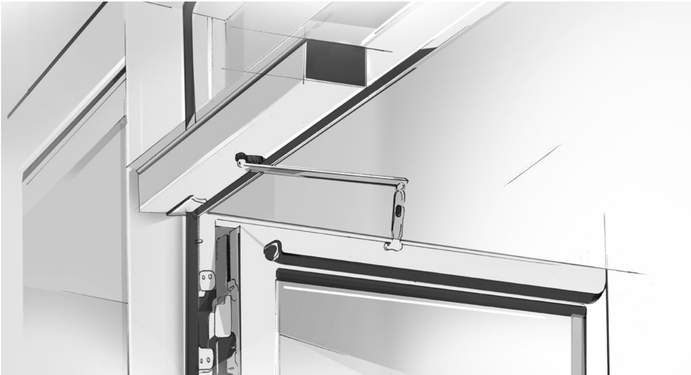
Beispielhafter elektromotorischer Antrieb mit Sensorleisten.
