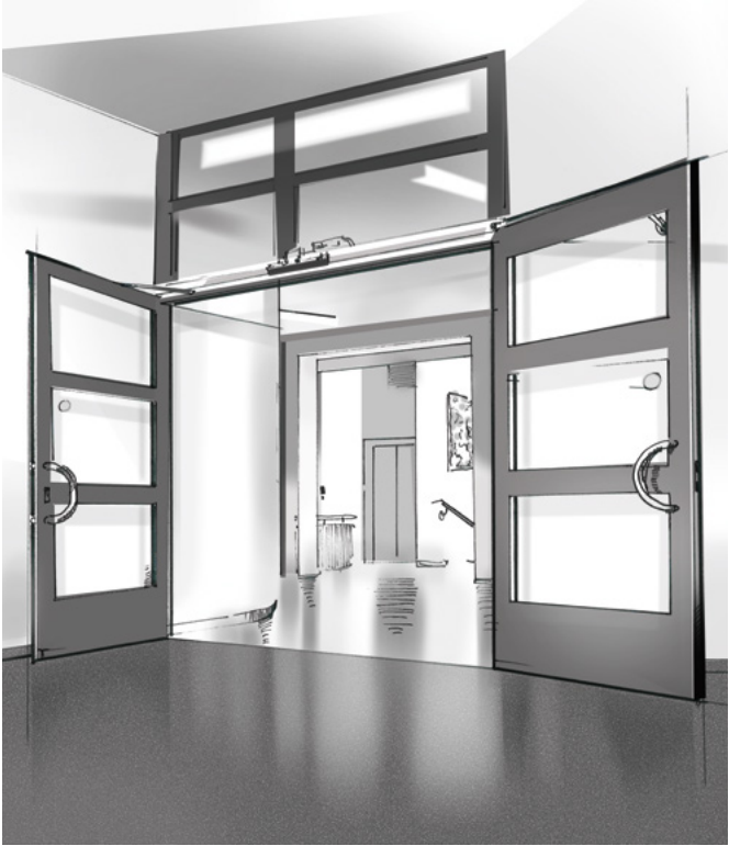
Beispielhafter Aufbau einer Brandschutztür mit Feststellanlage.
