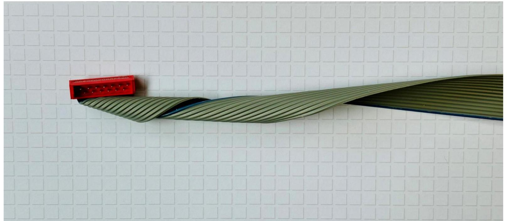
Durch Eindrehen des Kabels bzw. auch des Anschlusssteckers, kann die Leitung auch durch Engen bis zu ca. 15mm verlegt werden.
